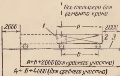
Рис. 19. Определение длины ремонтного участка крановых троллеев.
